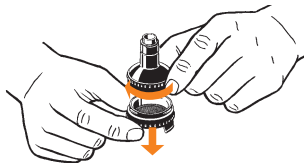
Deksel van de vulkamer vastschroeven
