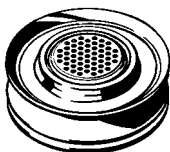
La Capsule Doseuse installée dans le Réducteur de la Chambre de Remplissage
