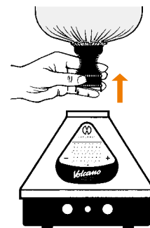
Quitar el Globo de Válvula y la Cámara de Relleno
