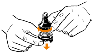
Enroscar la Tapa de la Cámara de Relleno
