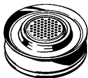
Kapsułka dozująca w reduktorze komory napełniania
