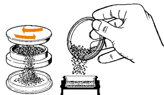
Napełnianie komory napełnienia
